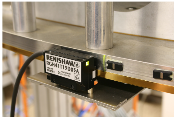
Abbildung 2.7. – Foto des optischen Encoders und dem optischen Maßband an der horizontalen Achse.
