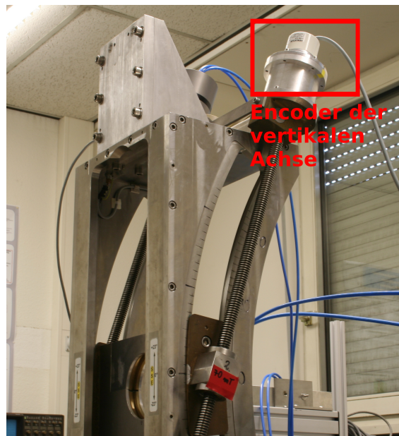
Abbildung 2.4. – Foto des Encoders der vertikalen Achse.
