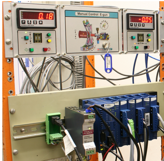
Abbildung 2.2. – Foto der Steuereinheit des Manipulators. Oben: Hardware zur Auslese der Encoder an den Achsen, Statusüberprüfung von Faltenbalk und der Sicherheitsendschalter und zum Umschalten zwischen manueller und softwareseitiger Steuerung des Manipulators. Unten: Controller der Firma National Instruments zur softwareseitigen Ansteuerung und Auslese der Manipulatorkomponenten.
