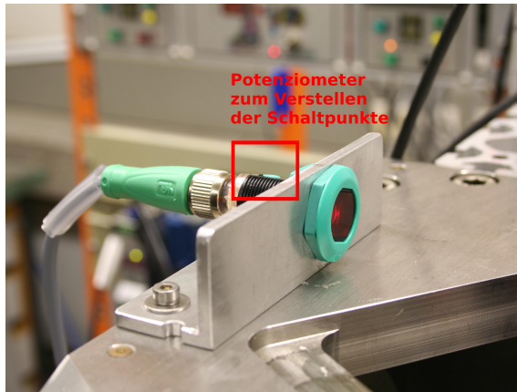
Abbildung 2.8. – Lichttaster mit Halterung an der horizontalen Achse.
