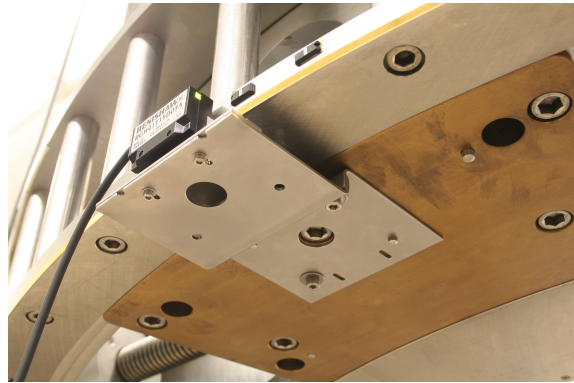
Abbildung 2.6. – Halterung für den optischen Encoder der horizontalen Achse.
