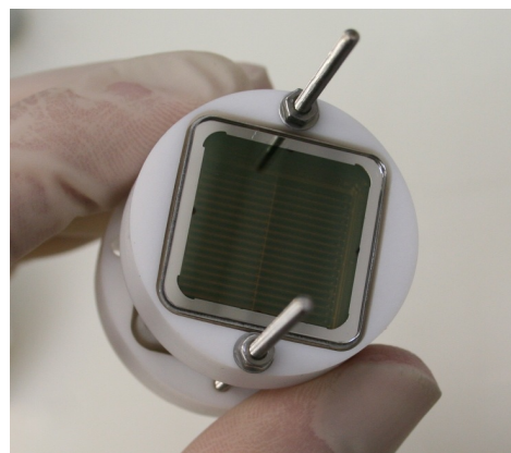
Abbildung 3.5: Draufsicht auf die Photokathode des verwendeten PMT. Hier ist der PMT schon in die PTFE-Halterung eingebaut.
