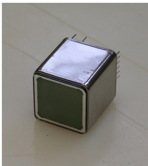
Abbildung 3.4: Aufnahme eines R8520-06-A1 PMT der Firma Hamamatsu. Am hinteren Ende erkennt man die Pins, welche zur Verbindung mit der Platine benötigt werden, um die Spannungsversorgung zu gewährleisten und das Messsignal zu erhalten.
