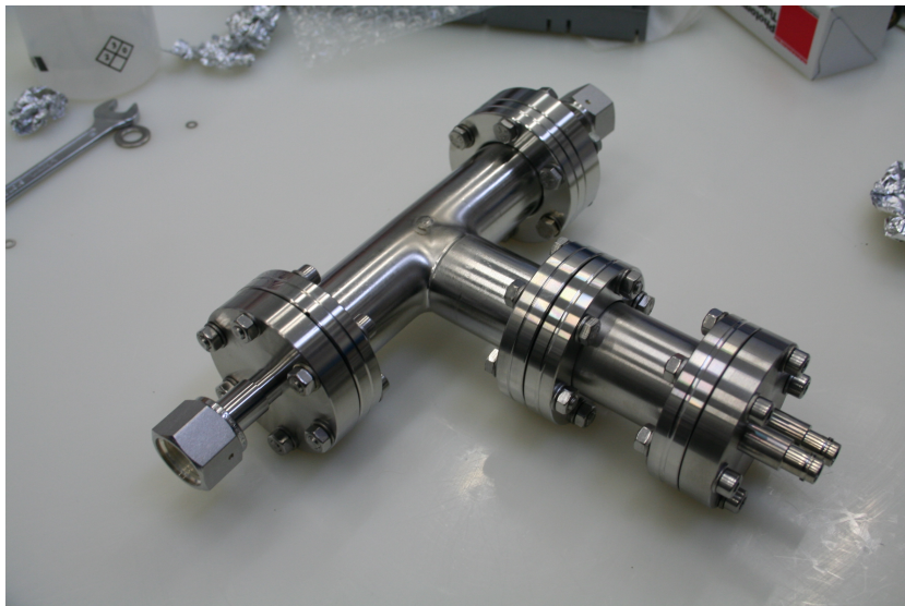
Abbildung 3.3: Abgeschlossener Aufbau der Messkammer. Zu sehen ist diese noch ohne radioaktive Quelle und Ventile.
