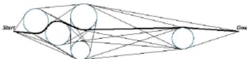
Abb. 6: Pfadplanung mit der Methode des erweiterten Sichtbarkeitsgraphen
