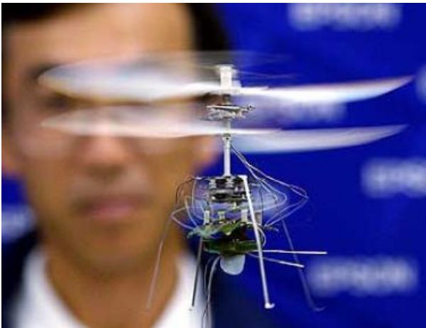
Abb. 6: Micro Flying Robot FR-I, von Seiko Epson. Der Roboter wiegt 8,9 Gramm, beinhaltet ein 2,5 Gramm schweres Kontrollmodul mit 2 CPUs, ein Bluetooth Modul mit 1,3 Gramm und ein CCTV-Videokameramodul.
