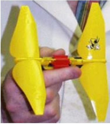
Abb. 5: Entomopter für den Einsatz auf dem Mars
