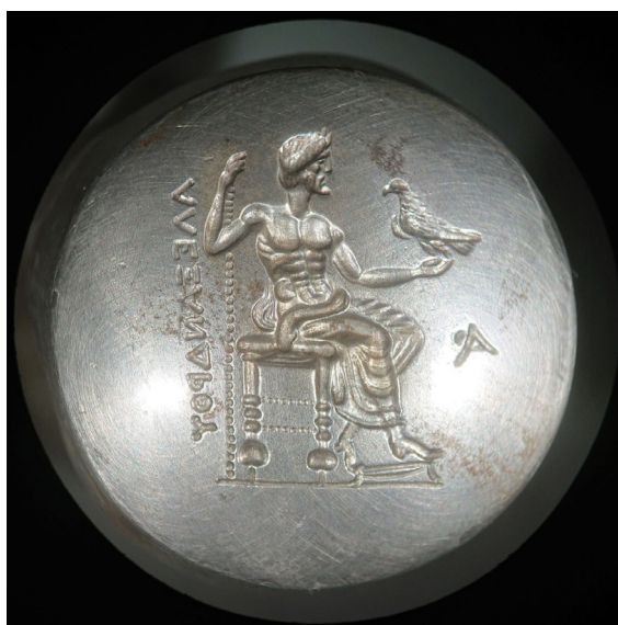
Abb. 15: Behandlung eines Münzstempels von Carl Wilhelm Becker. Entfernung von Korrosionsprodukten. Fotos: J. Dornheim
