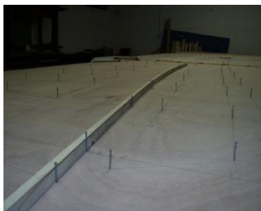
Abbildung 2.2: Straklatte im Schiffsbau
