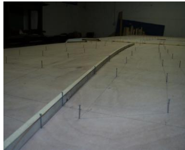
Abbildung 2.2: Straklatte im Schiffsbau
