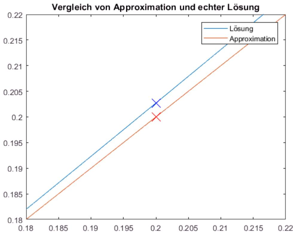
Dies führen wir nun genau so fort. Wir approximieren die Kurve durch die Tangente am Punkt  $(t_1, y_1)$  und berechnen daraus die Approximation  $y_2$  am Punkt  $t_2$ .
