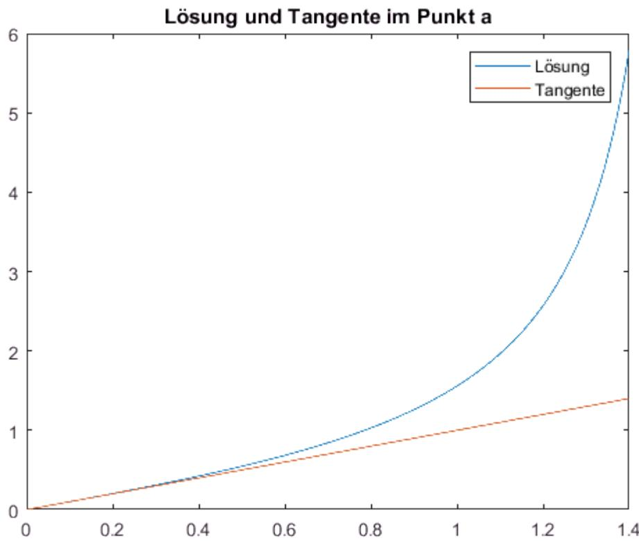
In der Nähe des Anfangswerts ist die Tangente eine gute Näherung für die Funktion. Wir approximieren daher den Wert der Funktion im Punkt  $t_1$  durch den Wert der Tangente im Punkt  $t_1$ , setzen also  $t_1$  in die Tangentengleichung ein. Dieses Verfahren heißt **Eulersches Polygonzugverfahren**. Wir erhalten
