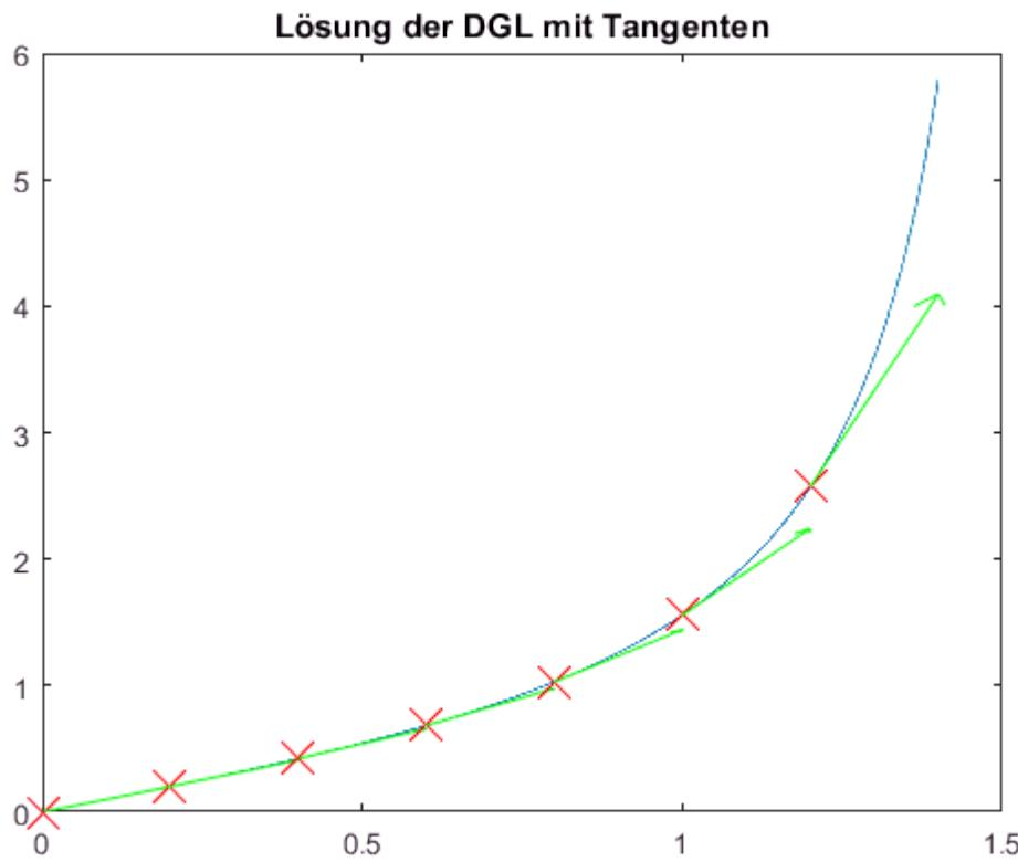
Ok, das scheint zu stimmen. Wir versuchen jetzt, diese Kurve numerisch zu approximieren. Die Idee ist: Wir wählen einige Werte  $a = t_0 \dots t_M = b$  im Intervall  $[a, b]$  und versuchen, an diesen Punkten Näherungen  $y_0 \dots y_M$  für den Wert der Funktion  $y$  bzw. die Punkte der Kurve zu finden. Wir beginnen zunächst mal mit 5 Punkten und zeichnen deren x-Positionen.
