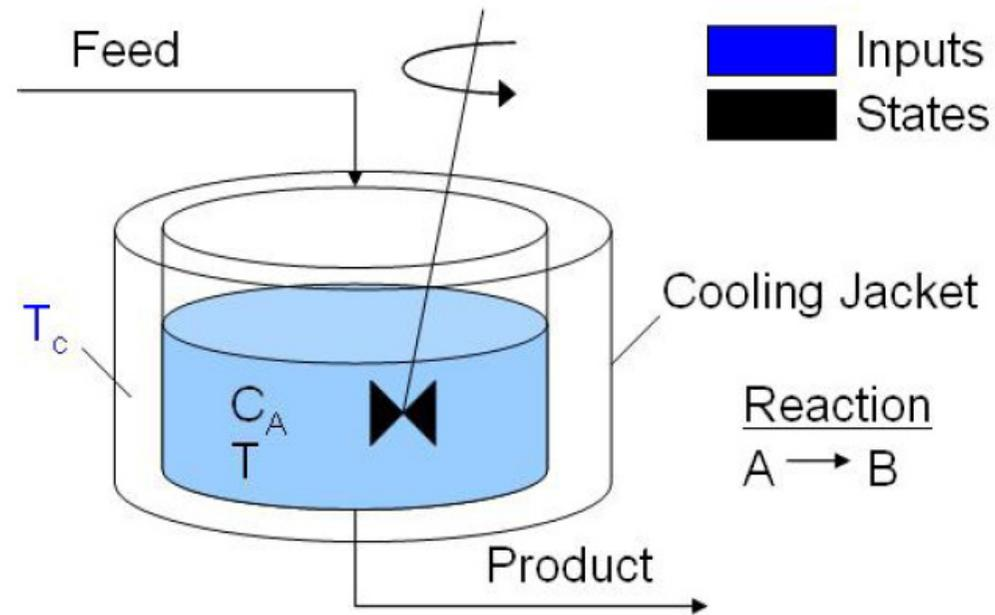
Abbildung 5.1: Schematische Darstellung eines kontinuierlichen idealen Rührkessels
