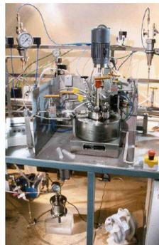
Abbildung 5.2: CSTR Laboraufbau
