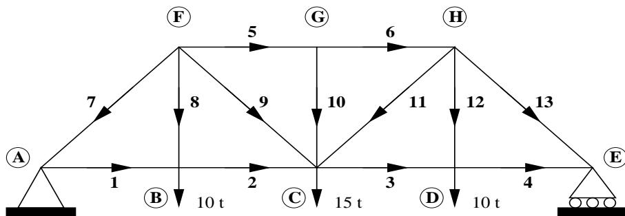
Die Figur stellt eine Brücke dar, die linksseitig fest montiert und rechtsseitig auf einem beweglichen Gerüst gelagert ist. Alle nichtdiagonalen Teilstücke seien gleich lang, d.h. die Diagonalen bilden mit den Nichtdiagonalen einen Winkel von 45 Grad.
