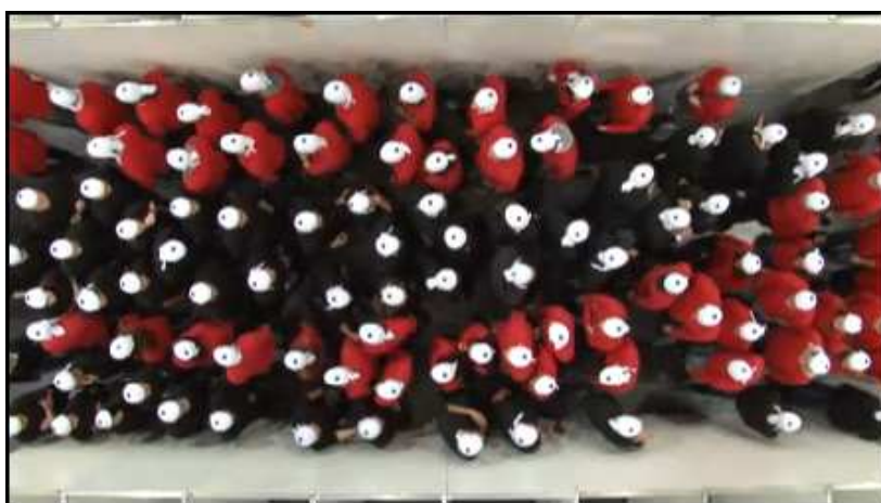
Abbildung 1: Spurenbildung in einem Experiment im Rahmen des Projekts „Hermes“ des Bundesministeriums für Bildung und Forschung [13]
