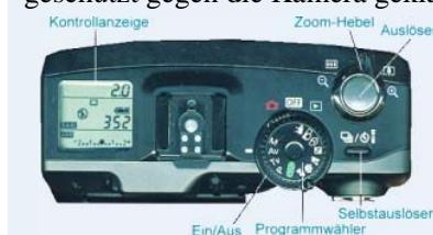
Die Oberseite der Kamera ist so etwas wie das Kontrollzentrum. Hier wird die Kamera eingeschaltet, hier wird ausgelöst und hier werden die Aufnahmeparameter kontrolliert.
