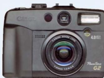
Die Canon Powershot G2 ist eine digitale Kamera, die auf einem CCD-Sensor mit 2272 x 1704 Fotosensoren und einem 10-Bit-Analog-Digital-Wandler basiert. Die Kamera ist in der Lage, Raw-Bilder zu speichern. Für die Speicherung der Bilder steht in der Kamera ein CompactFlash™-Speicher mit einer Kapazität von 1 Gbyte zur Verfügung.
