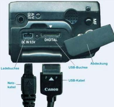
Die rechte Seite der Kamera dient der externen Versorgung. Hinter einer Abdeckung, die man zur Seite schieben kann, befinden sich zwei Buchsen.
