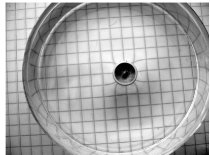
Abb. 7: Eine Heftzwecke „schwimmt“ trotz der größeren Dichte auf dem Wasser und driften vom Randmeniskus weg zur tiefer gelegenen Mitte.
