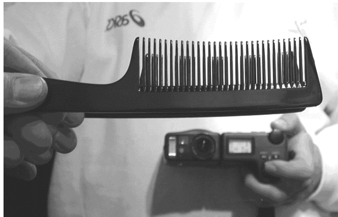
19 20 Abbildung 1 Freihandversuch mit Kamm. Interferenzstruktur von Kamm und Spiegelbild
