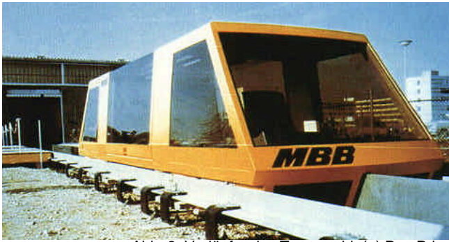
Abb. 2: Vorläufer des Transrapid: (a) Das Prinzipfahrzeug von MBB (EMS) (1971); (b) Der Erlanger Erprobungsträger EET (EDS) (1974)
