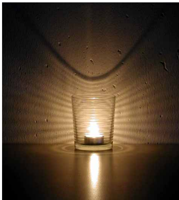
Abb. 4. Eine Struktur aus waagerechten Rinnen liefert ein ganzes Spektrum von Hyperbeln mit unterschiedlicher Öffnungsweite.
