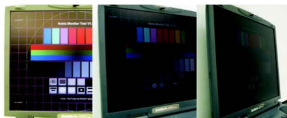
Abbildung 11: Die stark blickwinkelabhängige Lesbarkeit von Flüssigkristallanzeigen.
