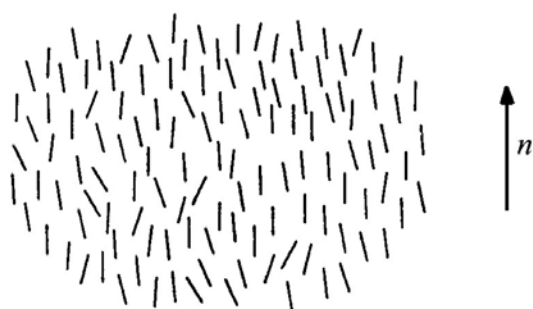
Abbildung 6: Schematische Darstellung der molekularen Orientierungsfernordnung mit Vorzugsrichtung in der flüssig-kristallinen (nematischen) Phase.
