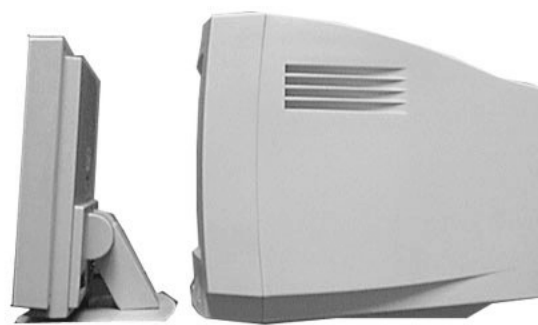
Abbildung 10: Vergleich der Bautiefe von TFT und Röhrenmonitor
