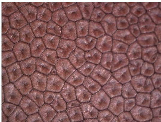
Bild 9: Polygonartige Muster offenbaren die innere Dynamik einer dissipativen Struktur am Beispiel der Bénardkonvektion. Im rechten Bild ist das mit Hilfe einer Computersimulation gewonnene vertikale Geschwindigkeitsfeld dargestellt.
