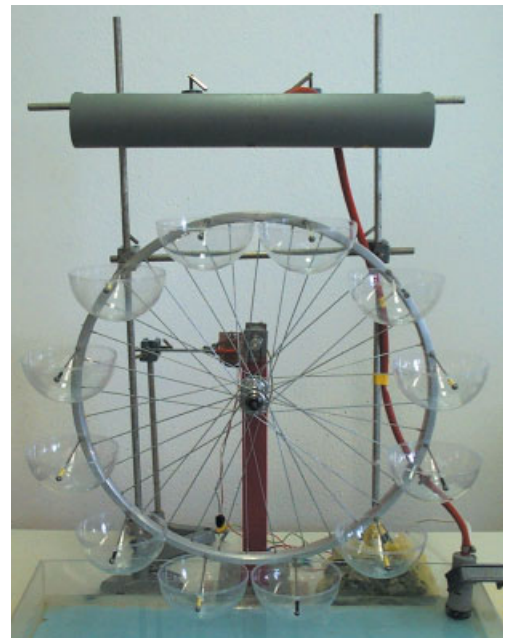
Abb. 3 Das chaotische Wasserrad im Experiment.
