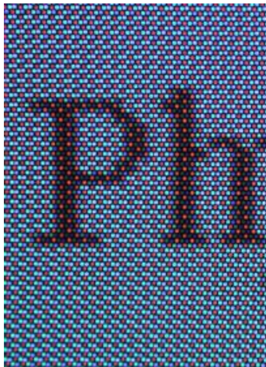
Abb. 2: Kleiner Ausschnitt aus einem "weißen" Bildschirm (Lochmaske) mit roten Buchstaben aus der Nähe betrachtet durch eine Mischung dreier Grundfarben erzeugt.
