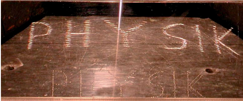
Abb. 3 In einer Plexiglasplatte ist unten das Wort PHYSIK gepunktet dargestellt. Darüber „schwebt“ das Wort im Raum.
