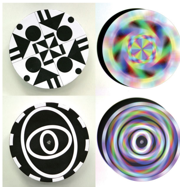
Abb. 4 Drehbare Scheiben mit Schwarz-Weiß-Mustern. Links in Ruhe, bei Tageslicht, rechts in Rotation, bei Beleuchtung mit weißem Mischlicht eines DLP-Beamers.
