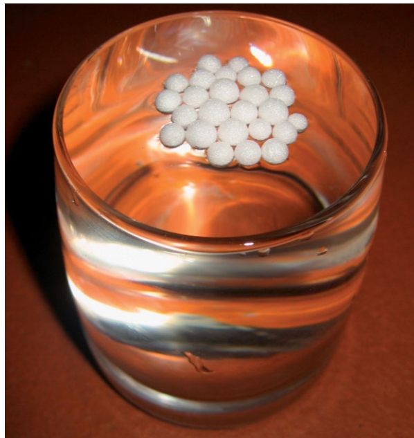
Abb. 2 Auf einer konvex aufgewölbten Wasseroberfläche driften Styroporkügelchen zur Mitte und bilden ein Kugelfloß.
