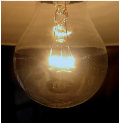
Abb. 3 Glühlampe mit realen Bildern des Glühdrahtes unter und über dem Glühdraht.
