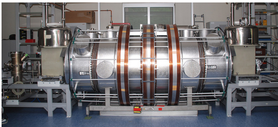
Abbildung 2.8: Das Monitorspektrometer. Zur Überwachung des Retardierungspotentials des Hauptspektrometers wird das Spektrometer des Mainzer Neutrinoexperimentes verwendet [Kat14].
