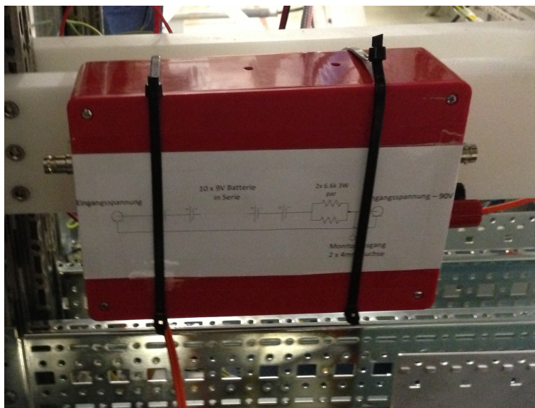
Abbildung 6.7: Im HV-Schrank installierte Batteriebox zur Erzeugung der -83 V Offsetspannung der winkelselektiven Photoelektronenquelle.
