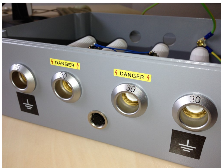
Abbildung 6.8: Plugbox zur elektrischen Entkopplung der winkelselektiven Photoelektronenquelle vom Hauptspektrometer.
