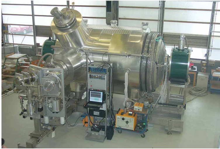
Abbildung 2.6: Das Vorspektrometer. Der zylindrische Tank besitzt einen äußeren Durchmesser von 1,70 m bei einer Wandstärke von 10 mm und einer Länge von 3,38 m. Die beiden Magnetspulen an den Spektrometerenden (türkis) sind im Abstand von 4,30 m aufgebaut und formen das magnetische Feld [Kat14].
