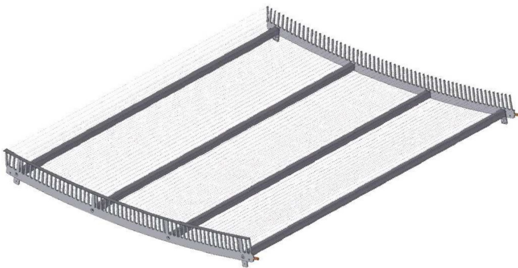
Abbildung 3.2: Schematische Schnittansicht des Hauptspektrometers. Zu sehen sind die Ringe 2 bis 16 des Elektrodensystems, die aus zweilagigen Drahtelektrodenmodulen bestehen. In rot ist der von einem Modul abgedeckte Bereich dargestellt [Zac09].
