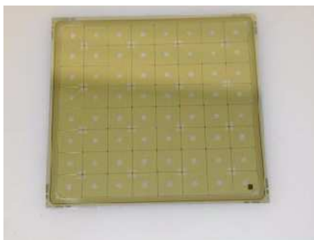
Abbildung 2.8: Segmentierte PIN-Diode mit 8 \times 8 Elementen. Eine solche Anordnung wird für den am Vorspektrometer einzusetzenden Halbleiterdetektor getestet.
