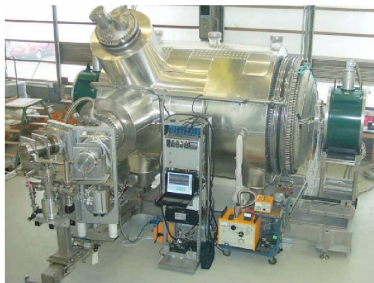
Abbildung 2.7: Das Vorspektrometer. Links ist eine schematische Abbildung zu sehen, rechts eine Fotografie des Vorspektromertanks nach der Auslieferung an das Forschungszentrum Karlsruhe im Oktober 2003 und nach der Montage des Heiz- und Kühlsystems.
